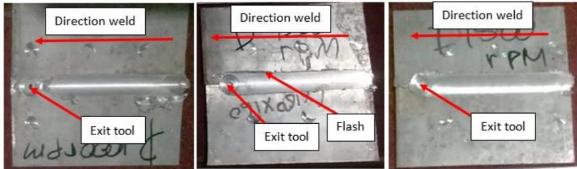
Figure 5: Macro Photo, a). 1000rpm, b). 1200 rpm, c). 1500rpm.
