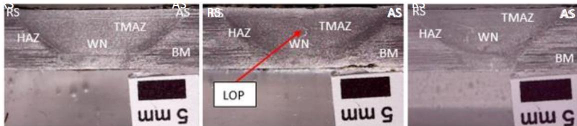
Figure 6: Cross Section, a). 1000rpm, b). 1200 rpm, c). 1500rpm.
